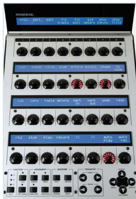
Im Verbund mit Mackies Traktion-Sequenzer lässt sich der C4 Pro auch stand-alone betreiben. Nach Druck auf den Function-Button sind die wichtigsten Steuerelemente anwählbar.
