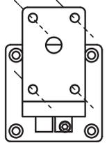
2. ドリルや穴あけ工具を使用してラグボルト アンカーボルトの直径より小さな穴を開けます。手順1でマーキングした4箇所全てに対して行います。
