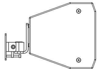
5. iP-シリーズスピーカーがブラケットにしっかりと固定されるまでしっかりと4つのネジを締め付けます。ラウドスピーカーから手を離す前にしっかりと固定されていることを確認してください。
