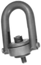
アイボルトの荷重限度は、角度がつくと極端に小さくなります。45°以上の角度で吊り下げる場合は、スウィベルホイストリングなどの金具を併用してください。このような金具は完全に回転するので、側面荷重を防止するのに役立ちます。
