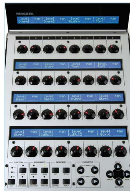
Drückt man den Track-Button, erlaubt der C4 Pro die Einstellung von Lautstärke und Panorama der ersten 16 Traktion-Kanäle. Die Bank- und Single-Buttons rufen weitere Kanäle auf.
