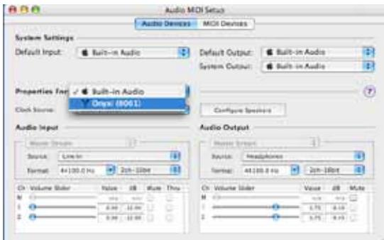
5. ここでミキサーの設定を見ることが出来ます。システム音声出力に使うよう指定する他、デフォルトの入力や出力を選ぶことも出来ます。Onyx 820iからの音声入力は8チャンネル、Onyx 820iへの音声出力は2チャンネルです。
