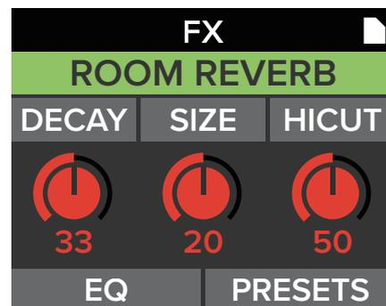
**DECAY** - このノブでリバーブのディケイタイム（リバーブの残響音がなくなるまでの時間）を調整します。選択したリバーブの種類により、値の範囲は異なります。
