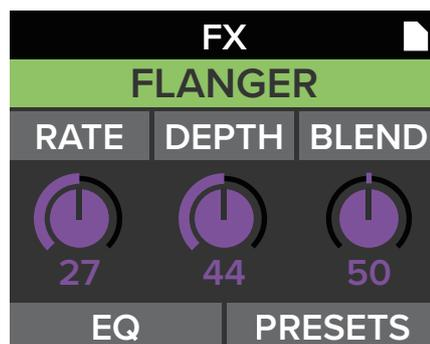
**RATE** - このノブで、ディレイモジュレーションの速度を設定します。選択したエフェクトの種類により、値の範囲は異なります。
