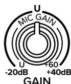
モノラルチャンネル (マイク入力とモノラルライン入力) では、GAIN ノブは入力感度を調整します。
