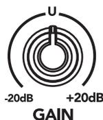
ステレオチャンネル(マイク入力なし)ではゲインコントロールはラインレベルインプットに対して作用します。ゲインは20dBの追加ゲイン~-20dBの範囲で調整できます。
