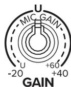
モノラルチャンネル（マイク入力とモノラルライン入力）では、GAIN ノブは入力感度を調整します。
